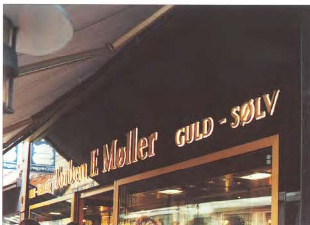
Korona-effekten gør, at kun bogstavernes konturer bliver oplyst, og ikke andre dele af facaden.
